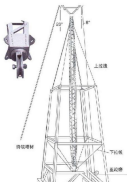
图 5-6 采用先进的内拉线悬浮抱杆分解组塔示意图
